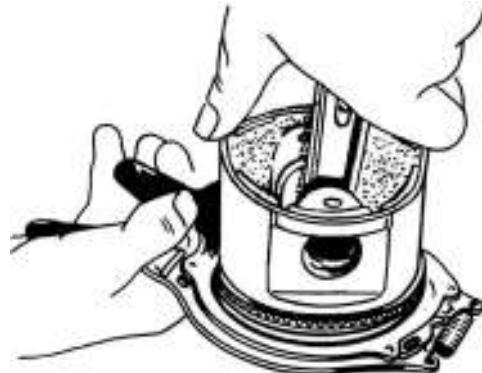
Рис. 3.2.46. Снятие поршневых колец с поршня съемником
