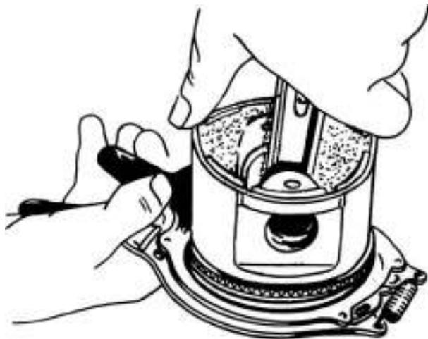
**Рис. 3.1.47. Снятие поршневых колец с поршня съемником**
